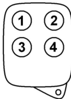
**Пример 3:** двойное нажатие кнопки 4 ручного передатчика СН4НТ с присвоенным выходом 2 приёмника, выбранным на шаге 2 выше, запрограммирует две последние кнопки на приёмник. Теперь кнопка 4 управляет выходом 2 и кнопка 3 – выходом 1. Кнопки 1 и 2 этого передатчика не будут активны для данного приёмника.
